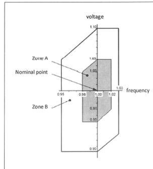
**ZONA A:** El motor nra de aportar el par nominal de forma continua. La respuesta del motor puede desviarse de los valores nominales y la temperatura superar a la nominal.
